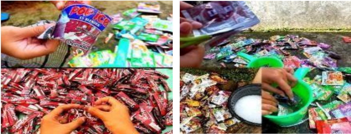
Gambar 3. proses menggunting, mencuci, dan mengeringkan sampah plastik kemasan.
