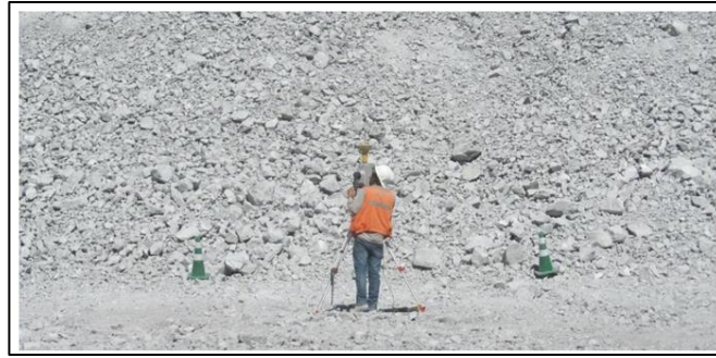
Gambar 4. Penempatan Laser Scanning Pada Muckpile (Onederra et. al., 2015)
